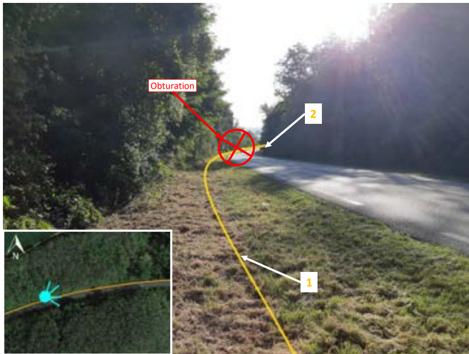
1 : Tronçon B DN150/125/100 BOURRET – MONTAUBAN ZI PARAGES à maintenir dans le sol en l'état - 2 : Tronçon C DN150/125/100 BOURRET – MONTAUBAN ZI PARAGES TSOA à déposer Figure 9 : Canalisation DN150/125/100 BOURRET – MONTAUBAN ZI PARAGES longeant la RD928 à l'ouest de la TSOA sur la Garonne
