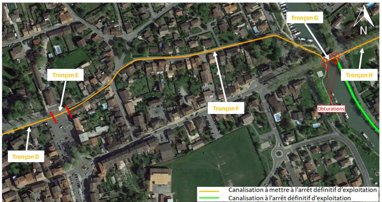
Figure 4 : Tronçonnage de la canalisation DN150/125/100 BOURRET – MONTAUBAN ZI PARAGES (2/4)
