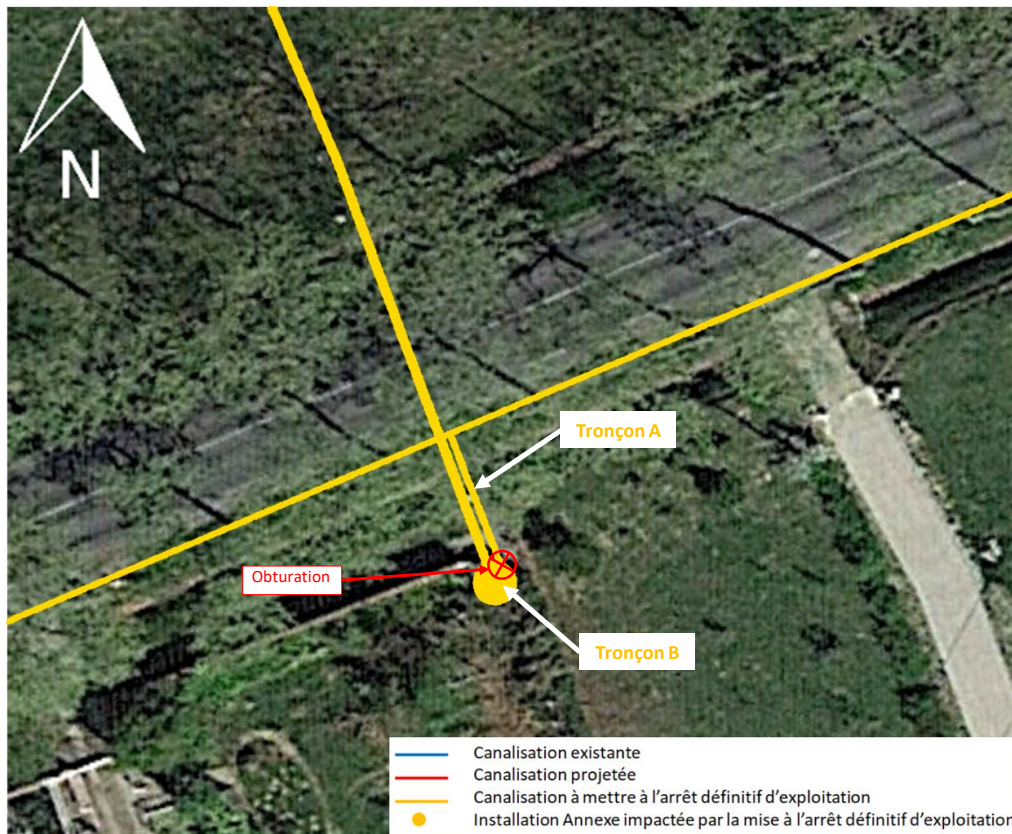
Figure 24 : Tronçonnage du branchement DN80 DEPART SINERG A MONTECH
