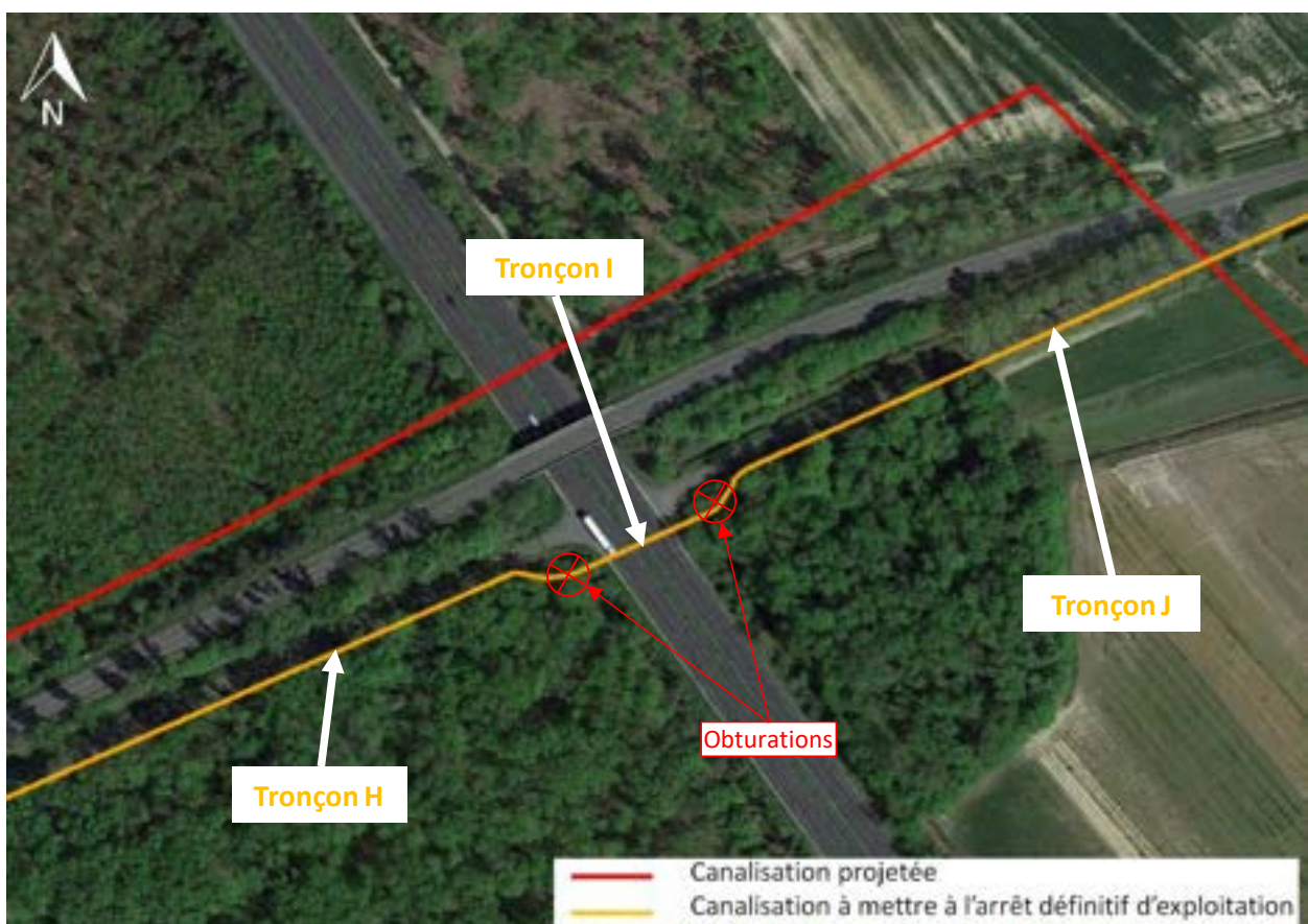
Figure 5 : Tronçonnage de la canalisation DN150/125/100 BOURRET – MONTAUBAN ZI PARAGES (3/4)
